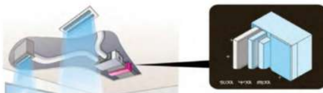
O FILTRO DE AR DE RENOVAÇÃO PM2.5 É COMPOSTO POR TRÊS CAMADAS DE COMPONENTES DE FILTRO QUE MELHORAM, DE FORMA ABRANGENTE, A QUALIDADE DO AR RENOVAADO
